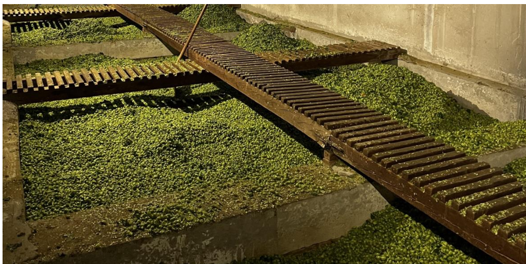
komorová sušárna chmele
